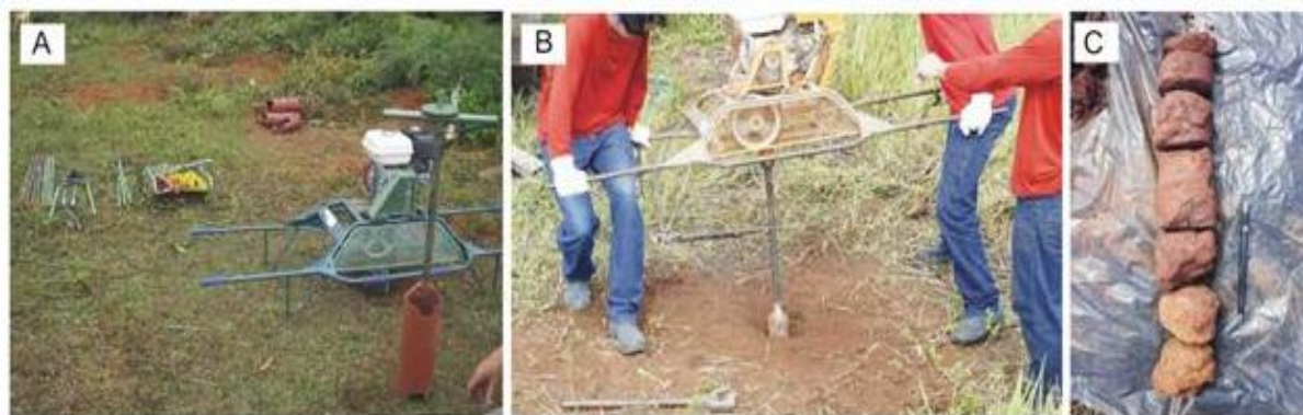
Figura 02 - Equipamentos e processo de amostragem. Trado mecânico motorizado (a). Operação de perfuração (b). Testemunhos de sondagem (c).
