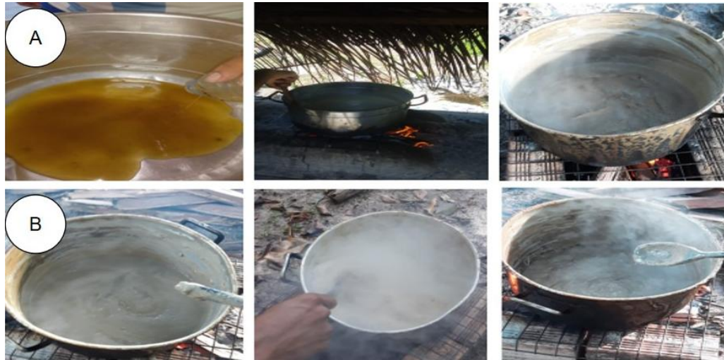
Figura 6- Hidrólise alcalina. (A) Óleo e lixívia levados ao fogo. (B) A consistência da mistura após a adição da lixívia por diversas vezes.
