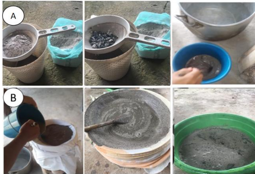
Figura 5 - Etapas de preparação da lixívia. (A) Peneiração e ação da água quente sobre as cinzas. (B) Filtração na estrutura com tecido amarrado no balde.
