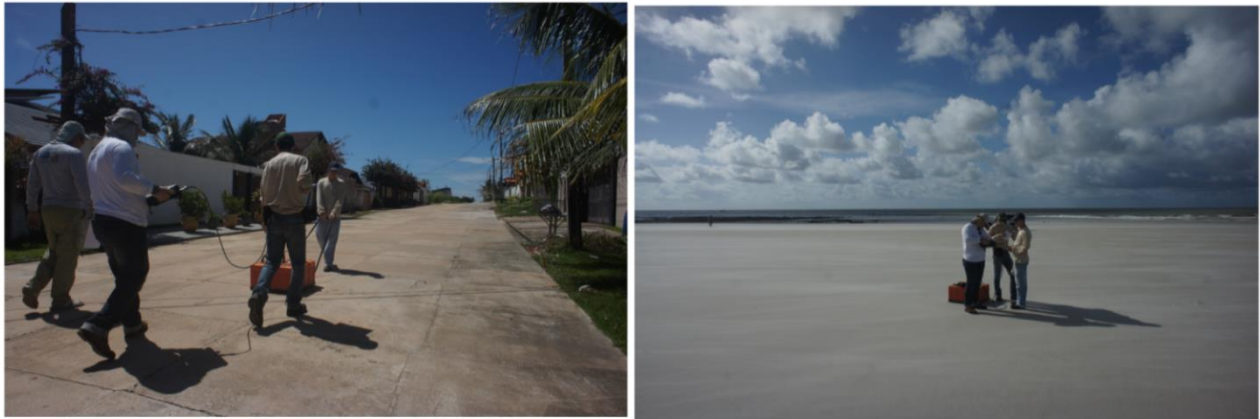
Figura 12- Aquisição de imageamento por GPR realizada na Praia do Atalaia tanto na via (esquerda) quanto na zona de arrebentação (direita).
