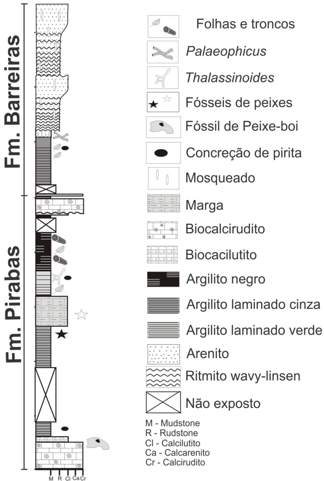
Figura 2- Perfil estratigráfico da Praia do Atalaia, Município de Salinópolis. O limite entre a Formação Pirabas e a Formação Barreiras é marcada pela ocorrência do último banco carbonático a 5m da base do perfil.
