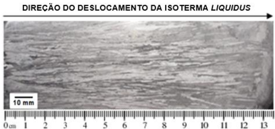
Figura 4.9 – Macroestrutura do lingote da liga Al3%Cu3%Ni.
