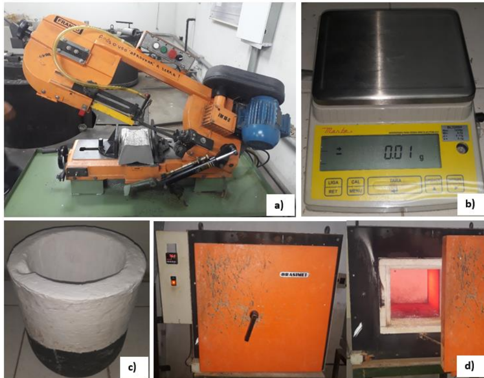
Figura 3.3. Equipamentos utilizados na preparação e fusão das matérias primas: a) Serra Elétrica de Fita; b) Balança Eletrônica de Precisão; c) Cadinho de Carboneto de Silício; d) Forno Elétrico Tipo Mufla.
