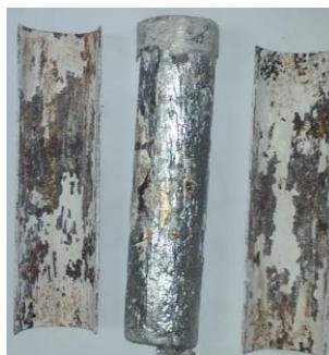
Figura 3.12 – Lingote produzido e desmoldado da liga Al3%Cu3%Ni.
