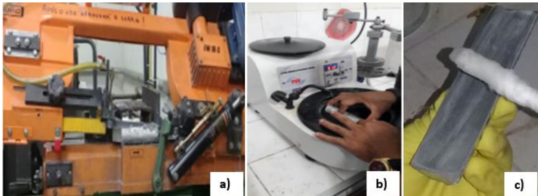
Figura 3.13 – Etapas da metalografia: a) Corte longitudinal do lingote, b) Lixamento da face obtida do seccionamento, c) Ataque químico na superfície lisa do lingote.
