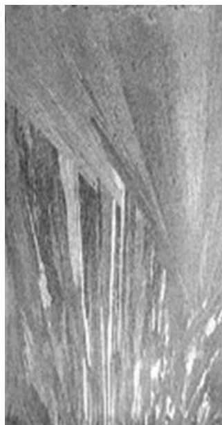
Figura 2.6 – Lingote Unidirecional de Alumínio com Alteração Induzida na Direção de Crescimento.
