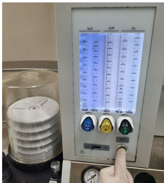
Figura 34 – Insuflação do fole para análise do desempenho do equipamento
