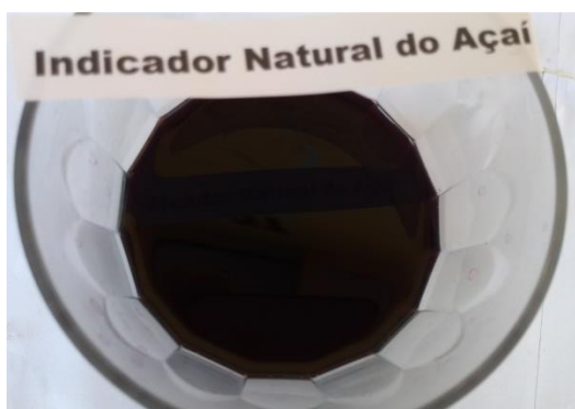
Figura 7: Indicador natural de pH a base de polpa de Açaí
