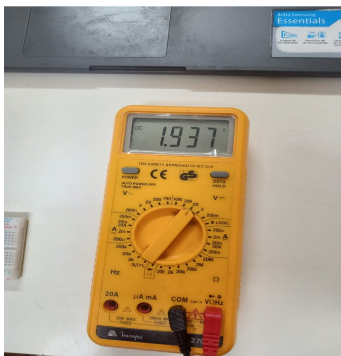
Figura 2.19: Valor experimental da tensão nos terminais do LED.
