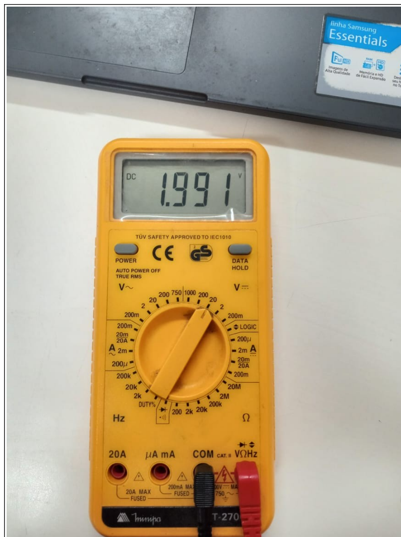
Figura 2.24: Valor experimental da tensão nos terminais do LED.
