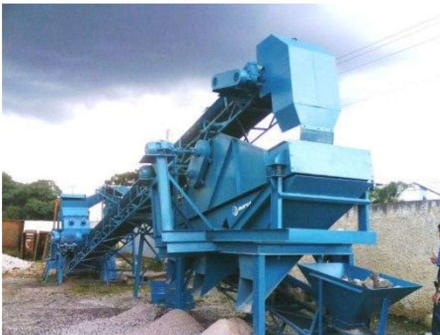
Figura 55 – Usina de reciclagem de RCD definida pela MRN
