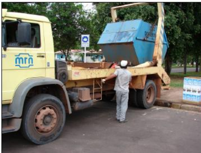
Figura 26 - Operação do caminhão Brook para colocação da caçamba.
