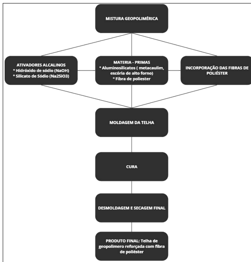
Figura 11 – Procedimento de mistura para preparação da pasta geopolimérica.
