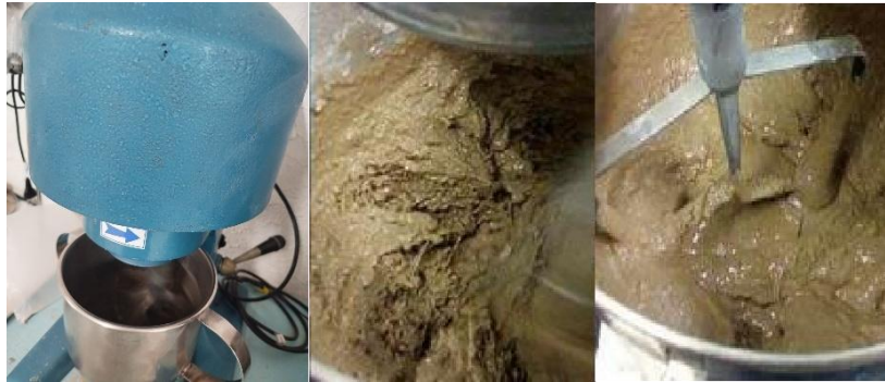
Figura 16 – Adição das fibras de poliéster no geopolímero e aparência física dos compósitos
