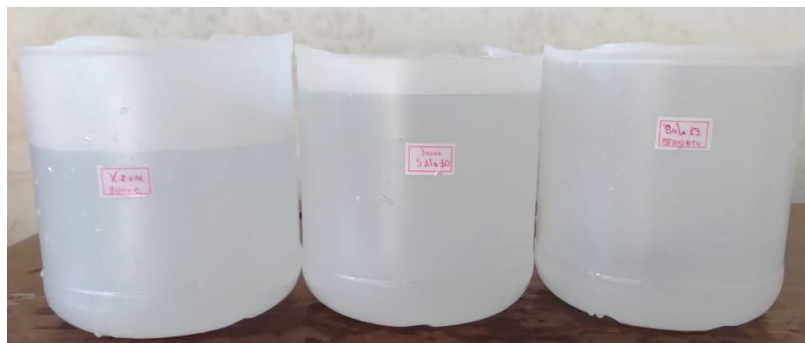
Figura 01: 2ª coleta - água expelida pelo ar-condicionado.
