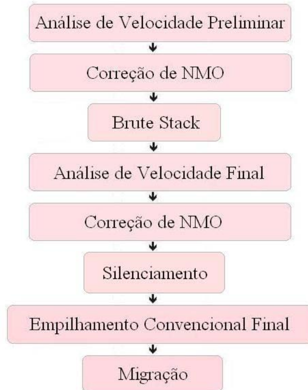
Figura 3.11 – Fluxograma das etapas de processamento avançado desenvolvidas durante o trabalho.
