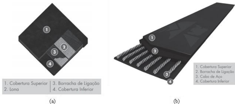
Figura 2. Componentes de uma correia transportadora (a) Correia transportadora de lona (b) Correia transportadora de cabos de aço.
