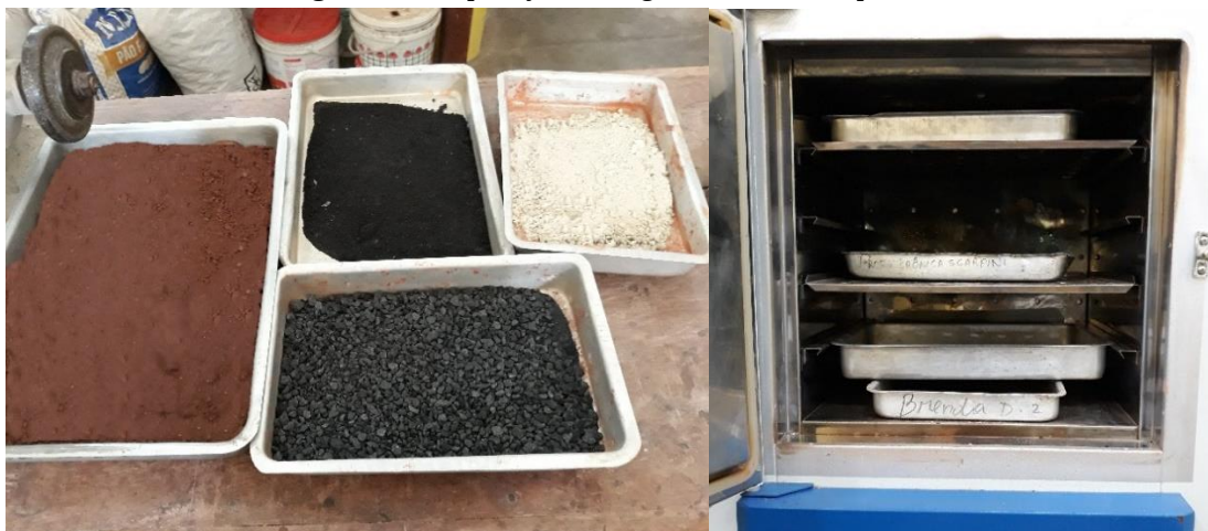
Figura 22 – Separação e secagem das matérias-primas.
