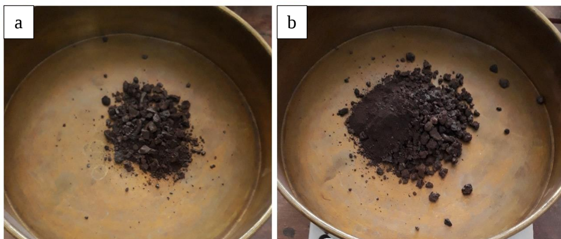
Figura 41 – Resultado do tamboreamento: (a) sínter 1 e (b) sínter 2.
