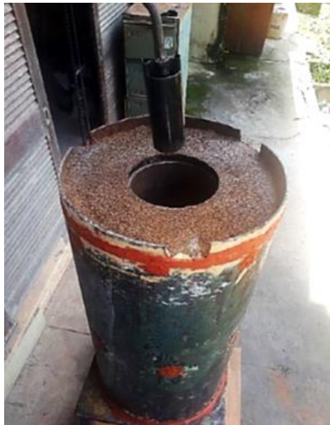
Figura 17 – Equipamento para o processo de ignição acoplado ao reator de leito fixo.
