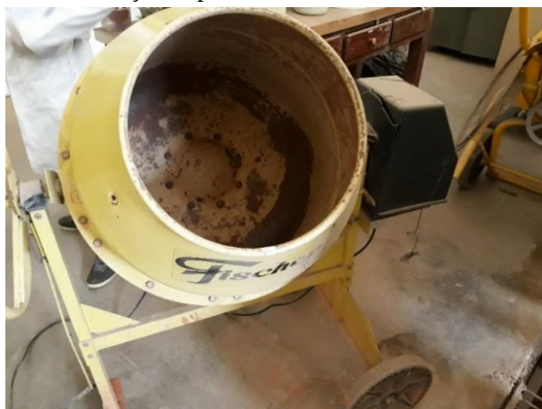
Figura 23 – Utilização do pelletizador na mistura das matérias-primas.
