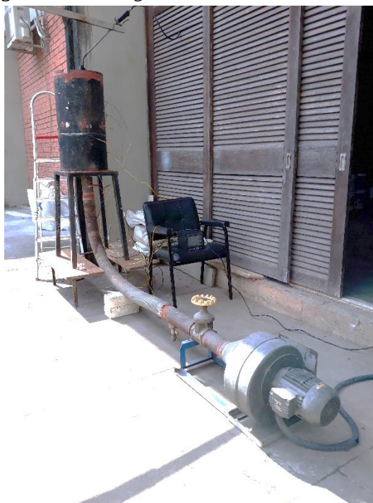
Figura 14 – Montagem do reator vertical de leito fixo.
