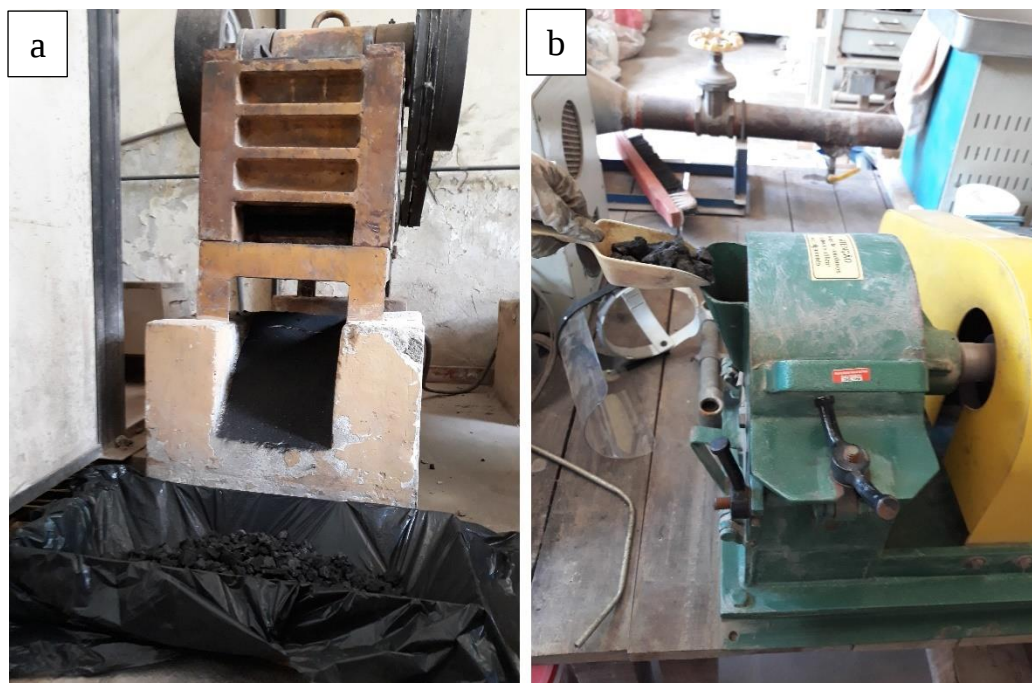
Figura 20 – (a) britagem da amostra de coque e (b) moinho de disco para redução granulométrica.
