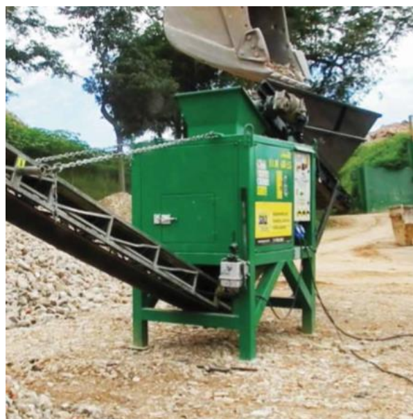
Figura 11: Britador Estacionário Portátil modelo - LEM 4825
