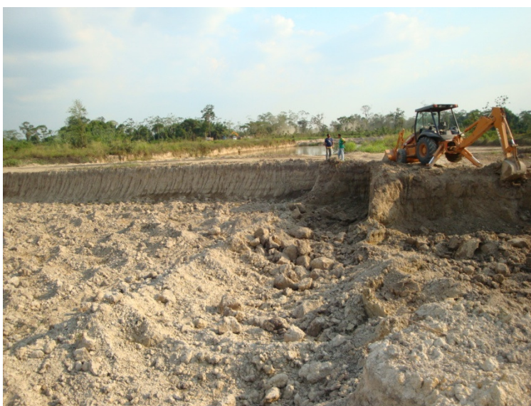
Figura 3: Espessura do nível argiloso retirado das frentes de lavras no município de Irituia. Espessura média de 3 m.
