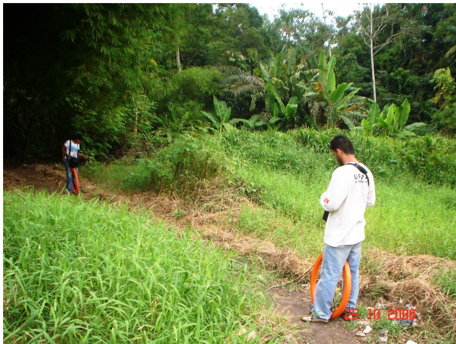
Figura 8 – Medidas de condutividade aparente com o arranjo de bobinas coplanar vertical ou dipolo horizontal.
