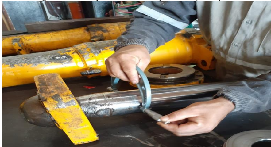
Figura 19. Utilização do micrômetro para avaliação do pistão.
