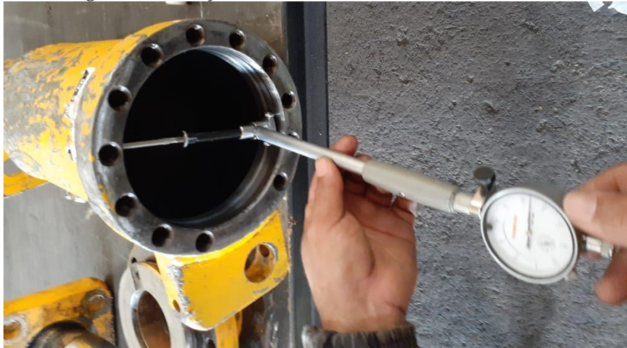
Figura 18. Utilização do instrumento súbito no cilindro hidráulico.
