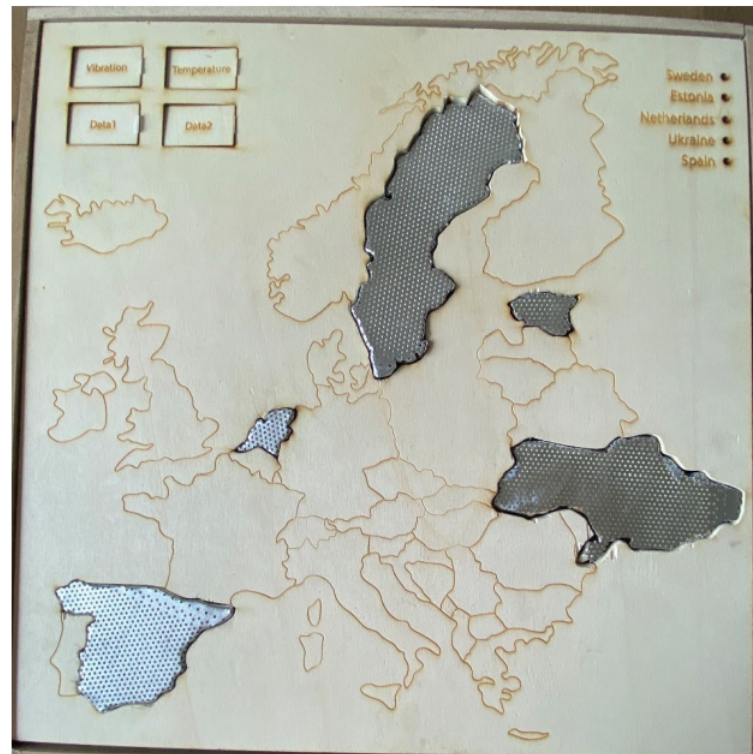
Figura 6. Mapa físico desenvolvido para codificar dados por meio da vibração e temperatura
