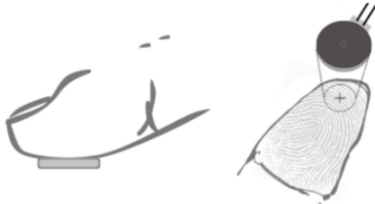
Figura 11. Esquema de interação com o motor de vibração
