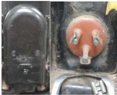
Figura 4. Localização dos terminais no compressor. Note que a sigla utilizada é a R-S-C.
