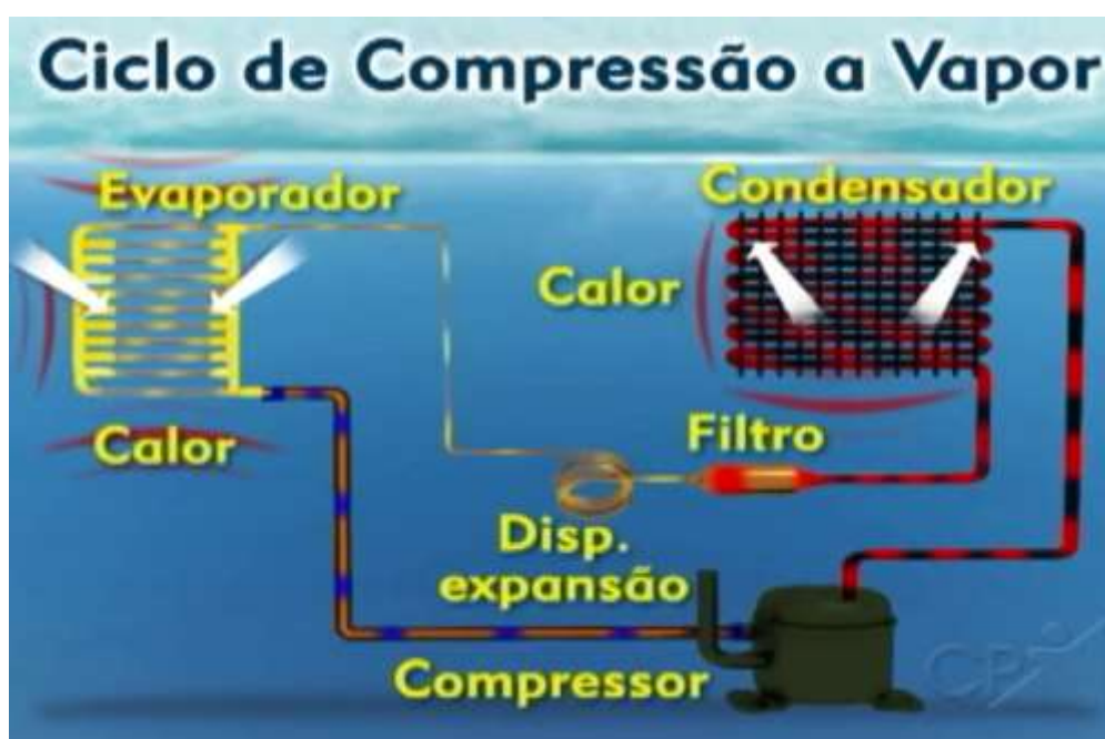
Figura 2. Representação esquemática de um equipamento condicionador de ar.
