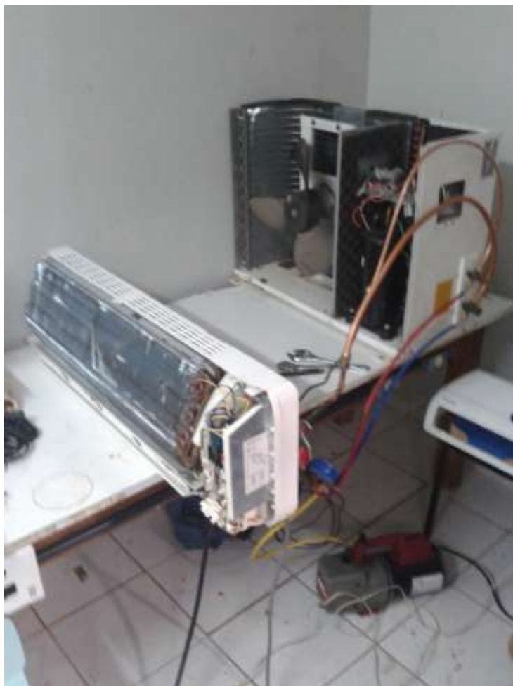
Figura 5. Inserção de vácuo no sistema feito com o auxílio da bomba de vácuo
