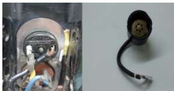
Figura 10. Protetor térmico instalado na caixa de ligação de um motocompressor. Podemos ver também um protetor térmico removido do motocompressor.
