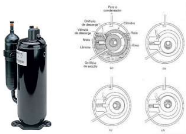
Figura 4. Compressor rotativo e sua representação esquemática. (a) Localização dos componentes; (b, c, d) Esquema de funcionamento.
