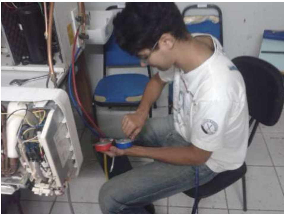
Figura 7. Momento da liberação do gás recolhido no compressor no sistema.
