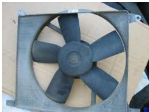
Figura 17. Ventilador da unidade condensadora.
