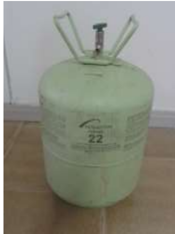
Figura 13. Botijão contendo gás refrigerante R22 ® .
