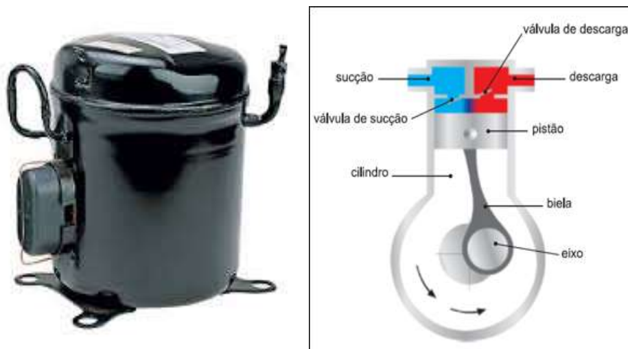
Figura 3. Compressor alternativo ou de pistão e sua representação interna.
