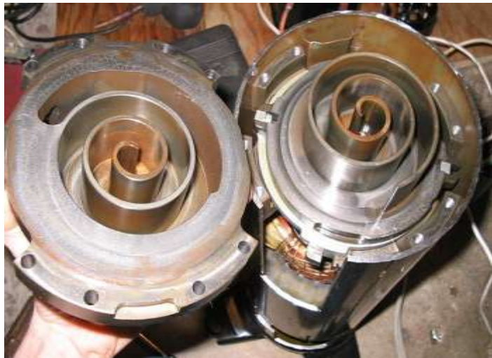
Figura 5. Detalhes do compressor scroll (parte interna).
