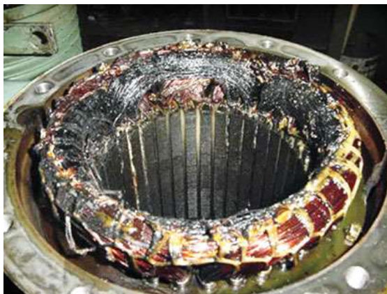
Figura 3. Carcaça de um compressor aberta para mostrar a bobina do motor
