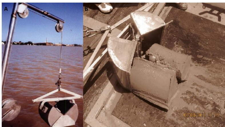
Figura 07: (A) Amostrador de fundo utilizado para as coletas das amostras e (B) Pegador de fundo mais amostra coletada.
