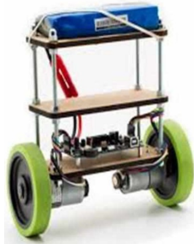
Figura 1.1 – Robô Pêndulo Invertido
