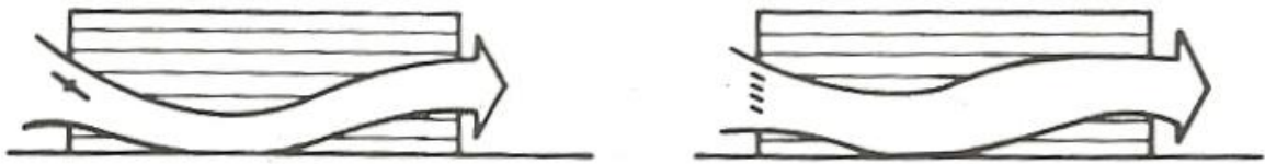
FIGURA 13 - Disposição de fluxo de ar através em ambientes que dispõe de aberturas localizadas em fachadas opostas.
