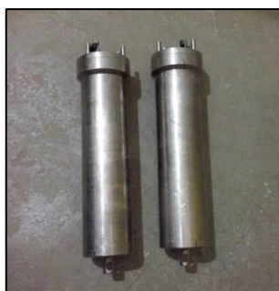
Figura 05 - Instrumentos equipados com sensor de pressão, utilizados na coleta de dados de onda.
