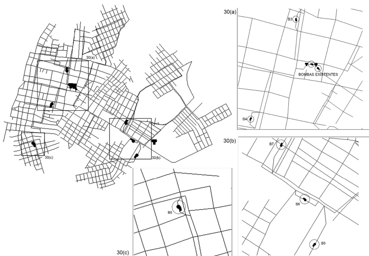
Figura 37 - Boosters na rede de distribuição
