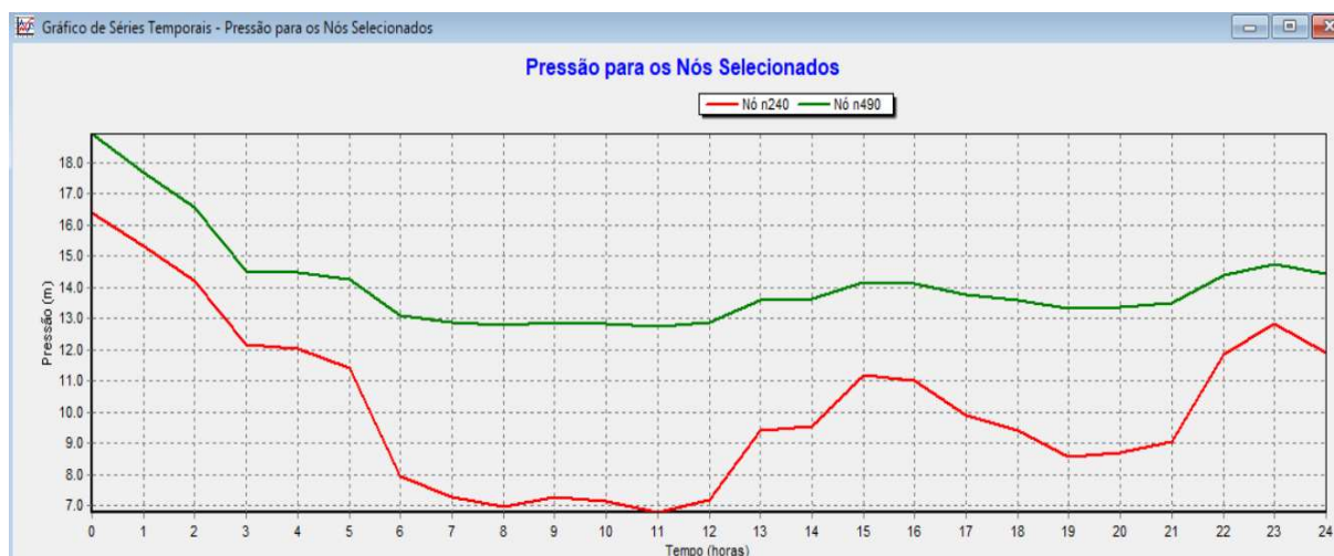
Figura 31 - variação da pressão ao longo de 24 horas nos nós n240 e n490.
