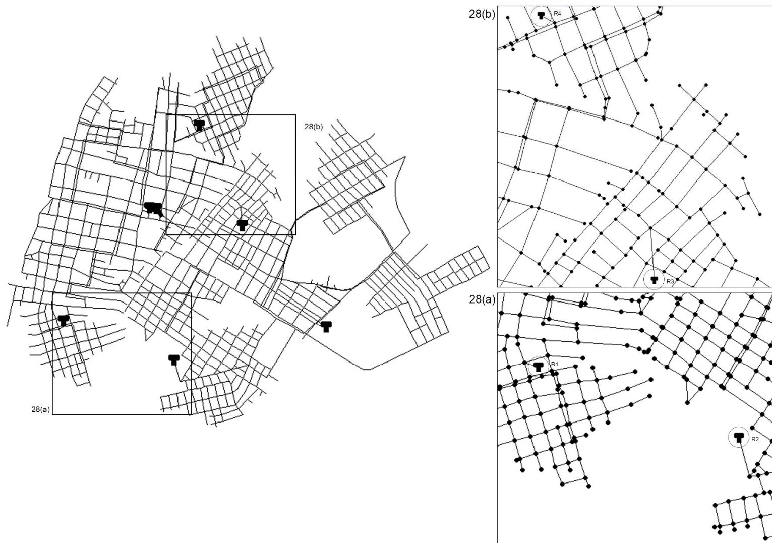
Figura 35 - Rede após a inserção dos quatro novos reservatórios
