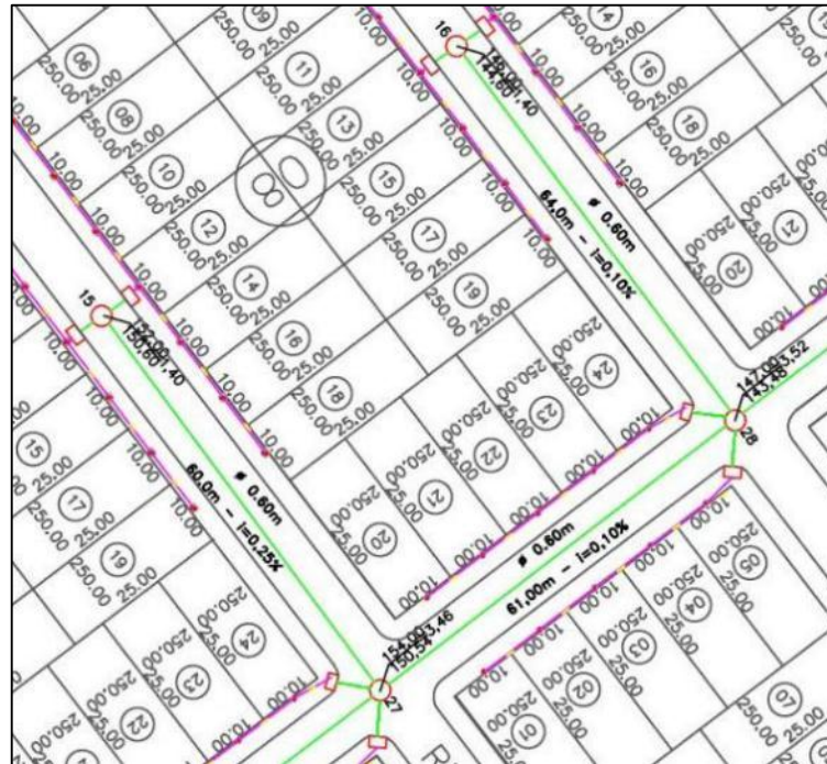
Figura 48 - Projeto de drenagem indicando poços de visita.
