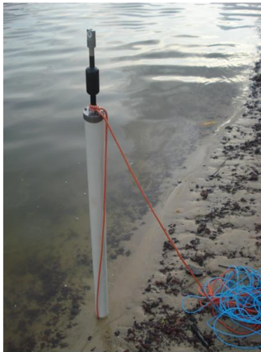
Figura 9: Correntômetro acoplado à um cano PVC utilizado na medição de corrente nos canais de maré estudados.
