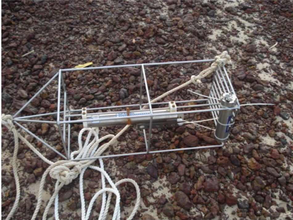
Figura 10: CTD SeaBird SBE 37 utilizado para medição de salinidade nos canais de estudo.
