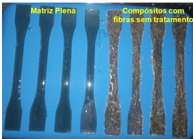
Figura 23 – Corpo de prova da matriz plena e do compósito sem tratamento alcalino.
