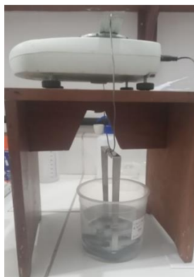
Figura 24 - Aparato utilizado para obter a massa imersa.
