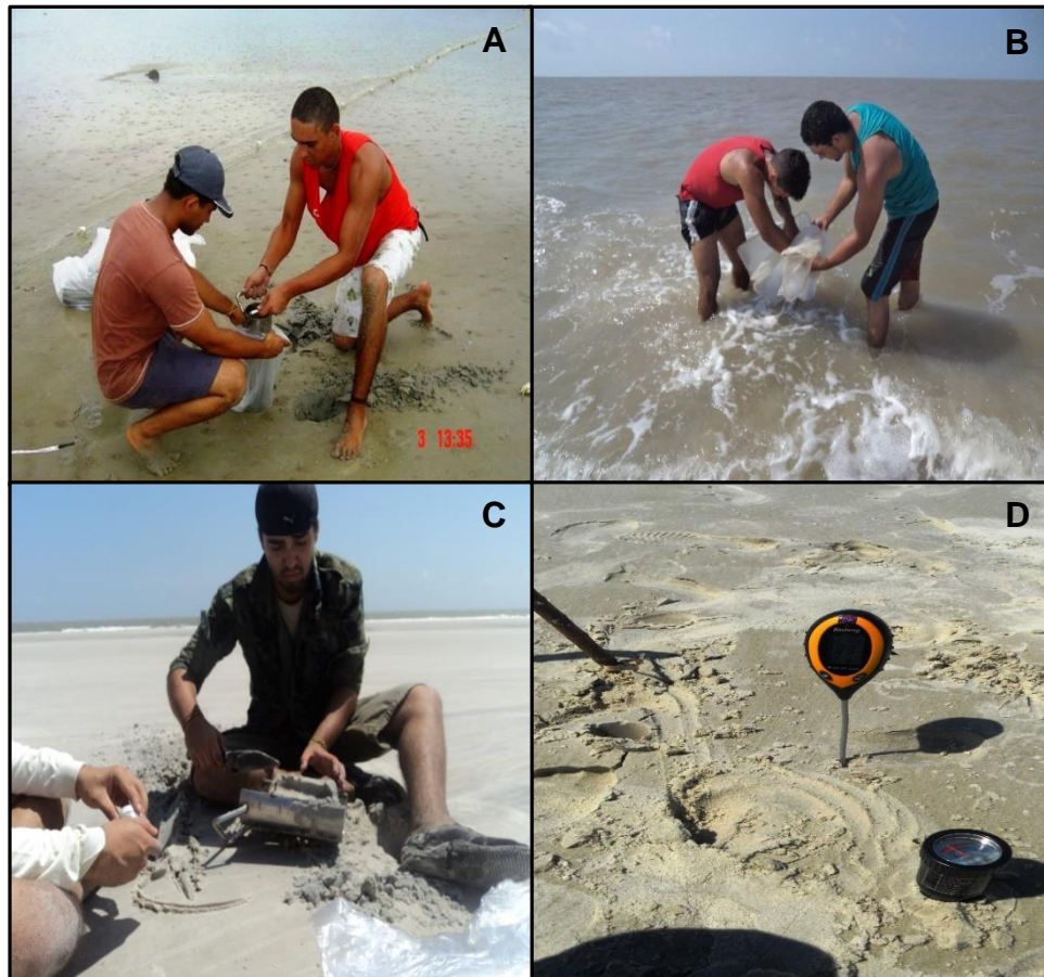
Figura 3: Coleta da macrofauna utilizando um amostrador cilíndrico (A), retirada do excesso de sedimento da amostra utilizando malha de 300 \mu\text{m} (B), retirada da amostra de sedimento para a determinação da M.O e do % de \text{H}_2\text{O} (C) e determinação da temperatura e umidade do solo (D).
