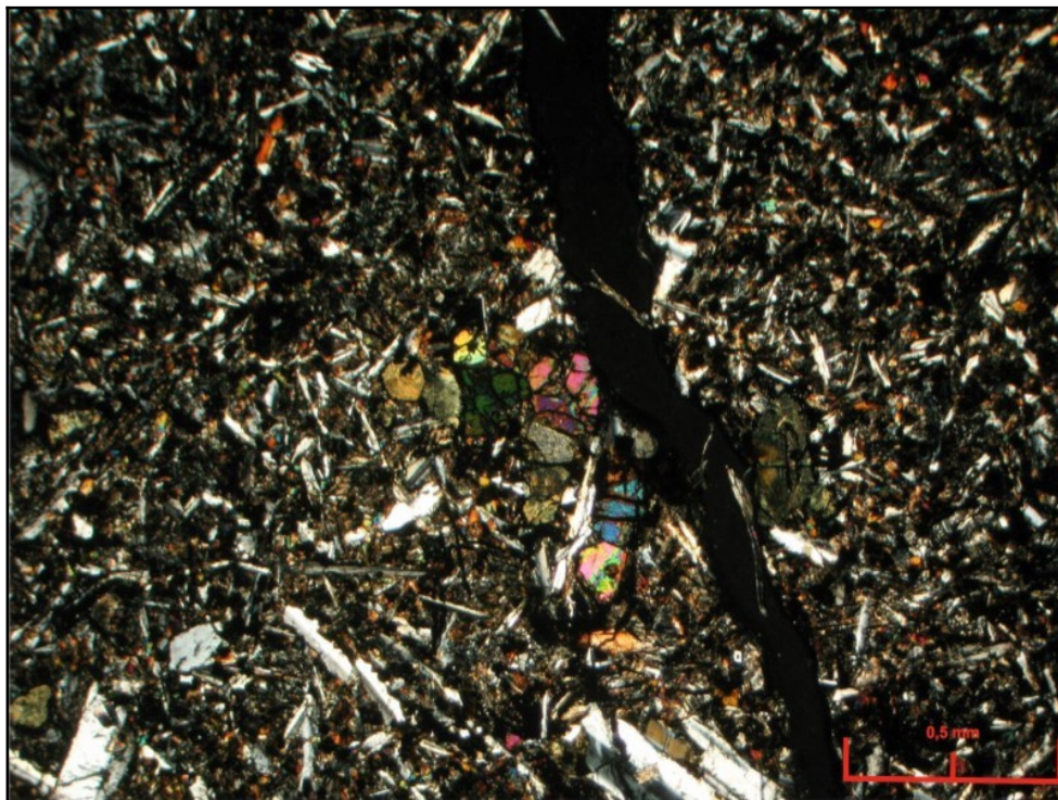
Fig. 20 – Fotomicrografia mostrando detalhe do arranjo textural glomeroporfírico em olivina-basalto. 2,5x; Nx. Ponto AT-2008-ASD/AS-15-B.
