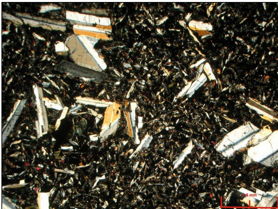
Fig. 19 – Fotomicrografia mostrando o aspecto textural porfirítico em olivina-basalto. A massa escura entre micrólitos de piroxênios na matriz corresponde a material desvitrificado. Objetiva 2,5x; Nx. Ponto AT-2008-ASD/AS-15-B.
