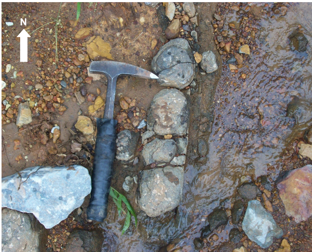
esfoliação esferoidal. Ponto AT-2008-ASD/AS-04-B.
