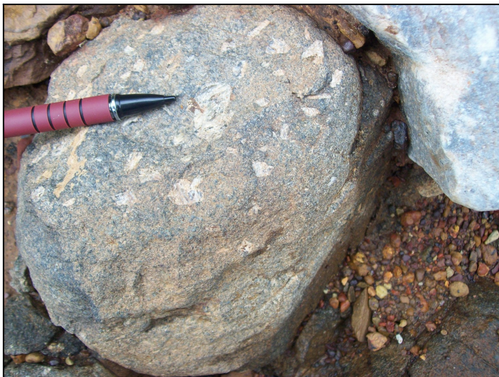
Fig. 10A – Diabásio porfirítico com destaque para cristais de plagioclásio com cerca de 1cm. Ponto AT-2008-ASD/AS-04-B.
