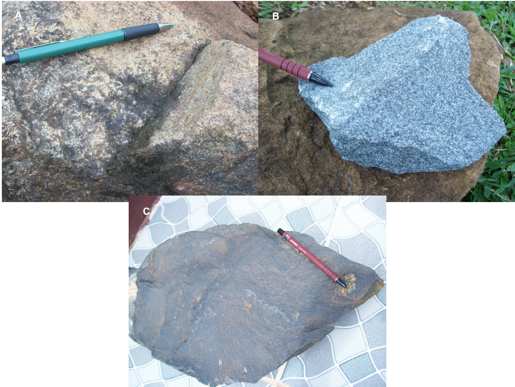
Fig. 11 – Detalhe da variação de granulação nas rochas máficas da região. (A): Diabásio de granulação grossa. AT-2008-ASD/AS-01-A; (B): Diabásio de granulação média. Ponto AT-2008-ASD/AS-12 e (C): Diabásio de granulação fina. Ponto AT-2008-ASD/AS-04-B.
