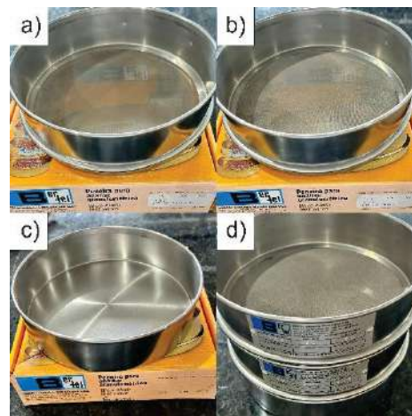
Figura 11 - a) Peneira de 80 mesh; b) Peneira de 200 mesh ; c) Fundo de peneira; d) Conjunto de peneiras utilizadas.
