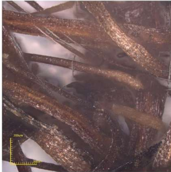
Figura 7 - Estrutura das fibras de açaí em escala de 200 nm.
