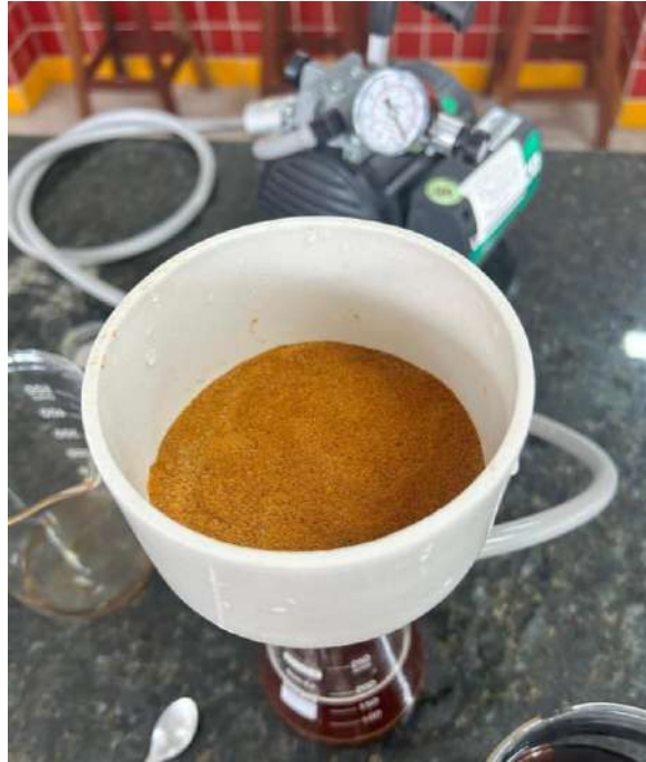
Figura 14 - Fibras após tratamento alcalino.
