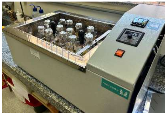
Figura 12 - Banho com agitação.
