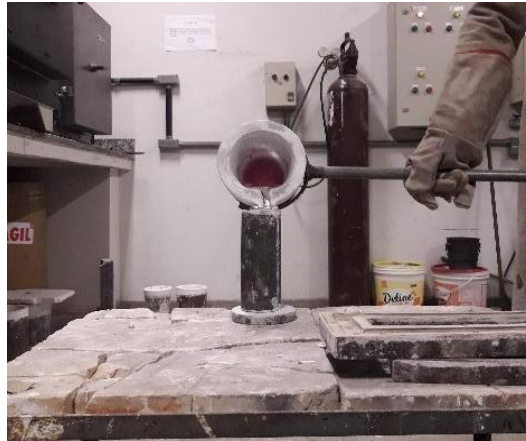
Figura 16 – Vazamento da liga Al- Si no molde coquilha.
