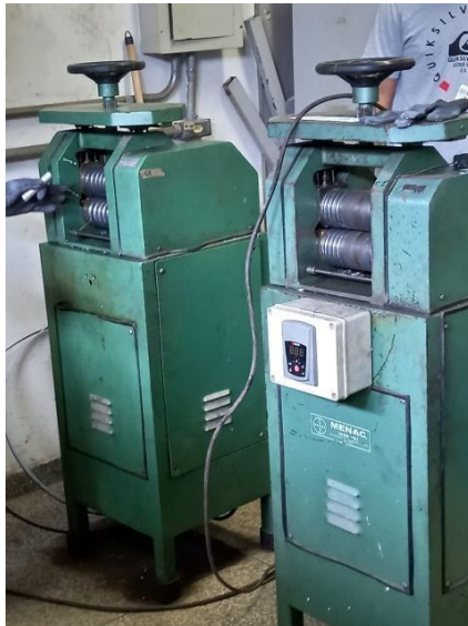
Figura 21 - Laminadores utilizados para laminação a frio.
