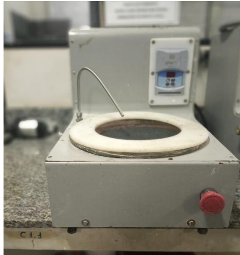
Figura 20 – Politriz utilizada para lixar e polir as peças.
