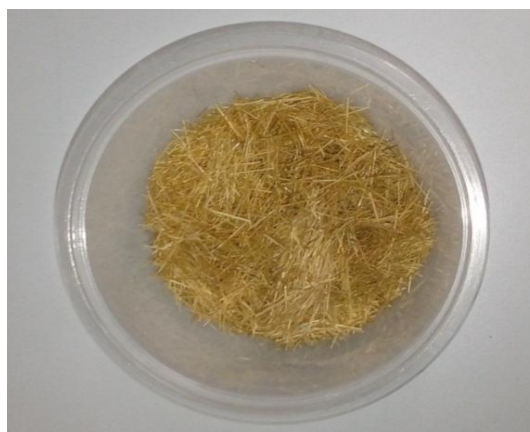
Figura 13 – Fibras de Bambu tratadas quimicamente.
