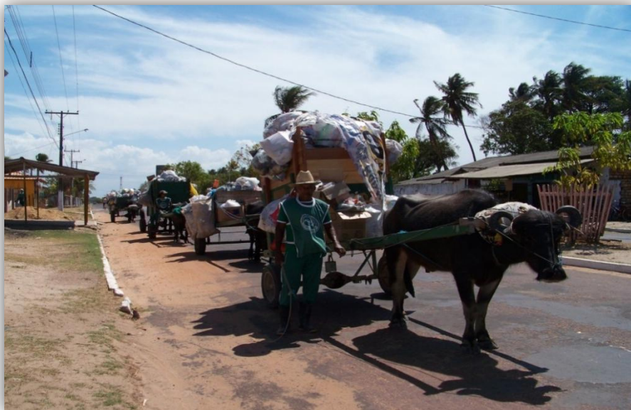
Figura 4- Carroças de 1 m 3 tracionadas por búfalos recolhendo lixo na cidade de Soure (PA)-2010
