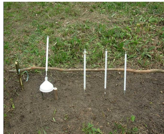
Figura 3. Geotermômetros em solo sem vegetação.
