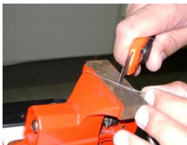
Fig. 3—Ranhuras sendo feitas na agulha.
