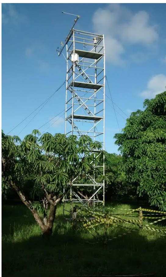
Figura 6- Vista da torre micrometeorológica e do sensor de medida da velocidade do vento.
