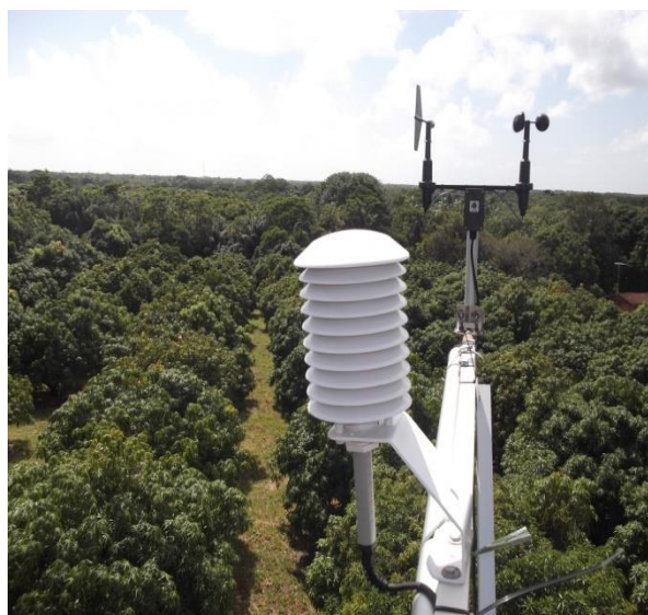
Figura 6- Vista da torre micrometeorológica e do sensor de medida da velocidade do vento.
