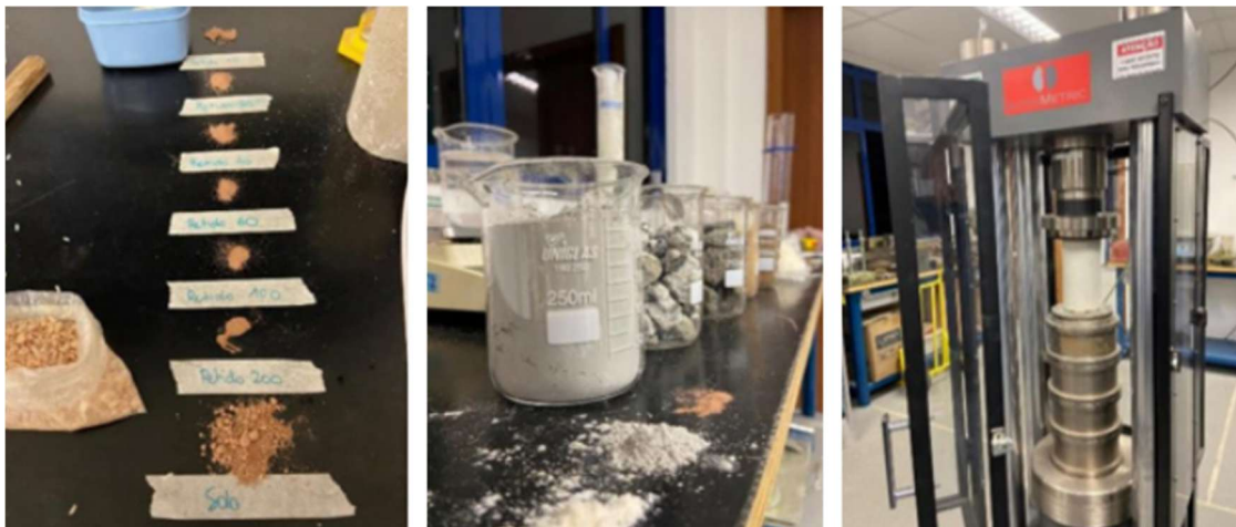
Figura 16 - Amostras de agregados e realização do ensaio de compressão.
