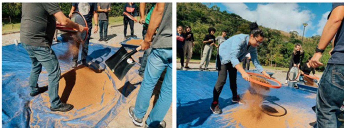
Figura 11 - Espalhamento e peneiramento do material.
