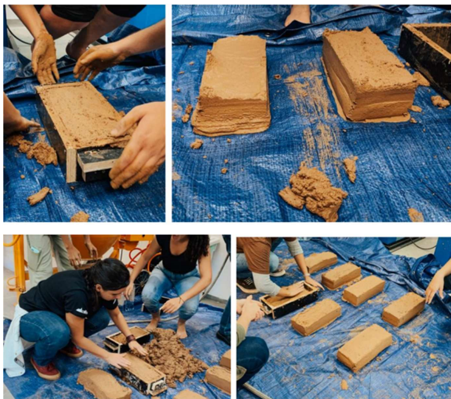
Figura 14 - Moldagem dos adobes.
