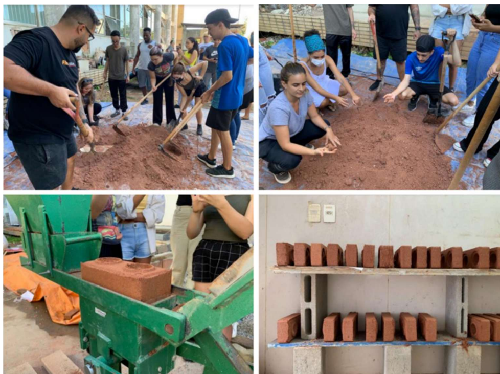
Figura 15 - Mistura e moldagem de BTC na oficina de integração interinstitucional.
