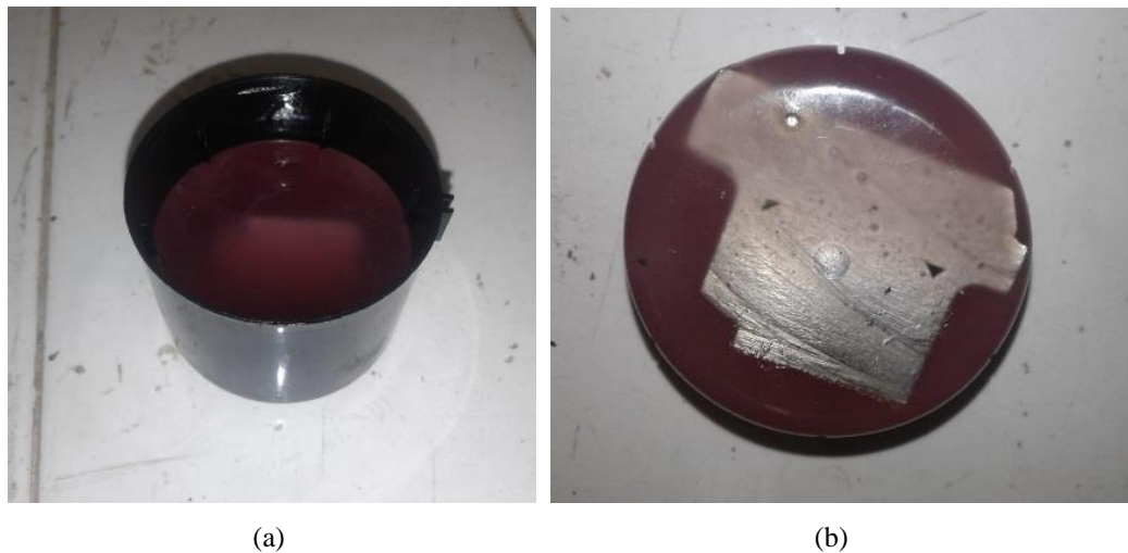
Figura 3.7 – Embutimento. a) Resina em cura, b) Amostra embutida.
