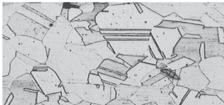
Figura 4.3 – Microestrutura típica de aço inoxidável austenítico.
