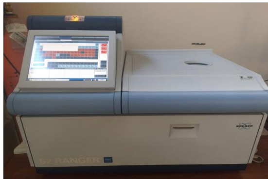
Figura 3.4 – Equipamento de Fluorescência de raio X (FRX).
