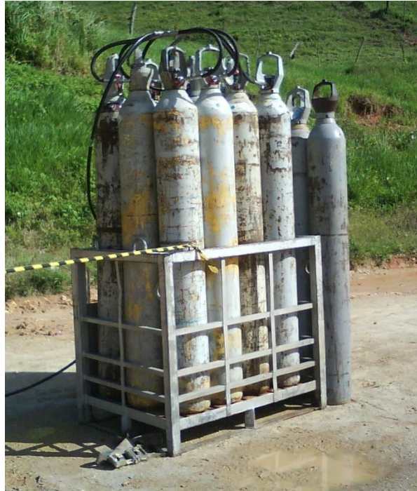
Figura 15 - Bombas de nitrogênio utilizadas no VSP.
