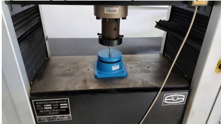
Figura 40. Disposição do amortecedor para o teste de compressão.
