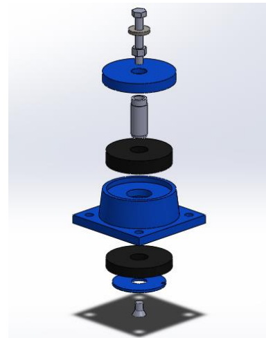
Figura 27. Vista explodida do modelo 3D do amortecedor.
