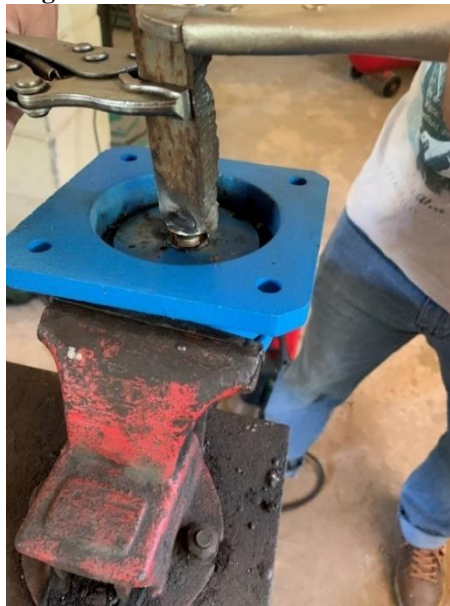
Figura 25. Desmonte do amortecedor.
