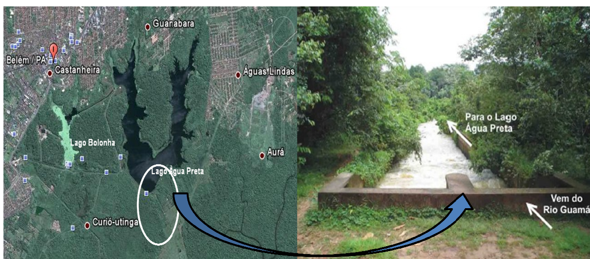
Figura 4: Imagens dos sistemas de adução e captação do rio Guamá. Fonte: SODRÉ, 2007; GOOGLE EARTH, 2010.
