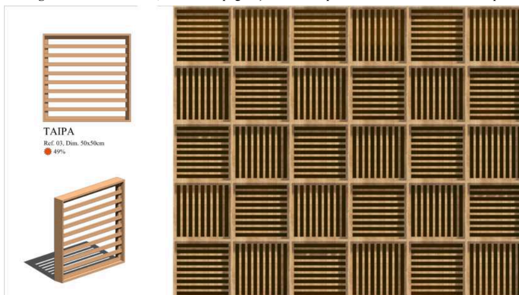
Figura 34 - Vista frontal, Vista 3D e paginação formada pelo Muxarabi Amazônico “Taipa”
