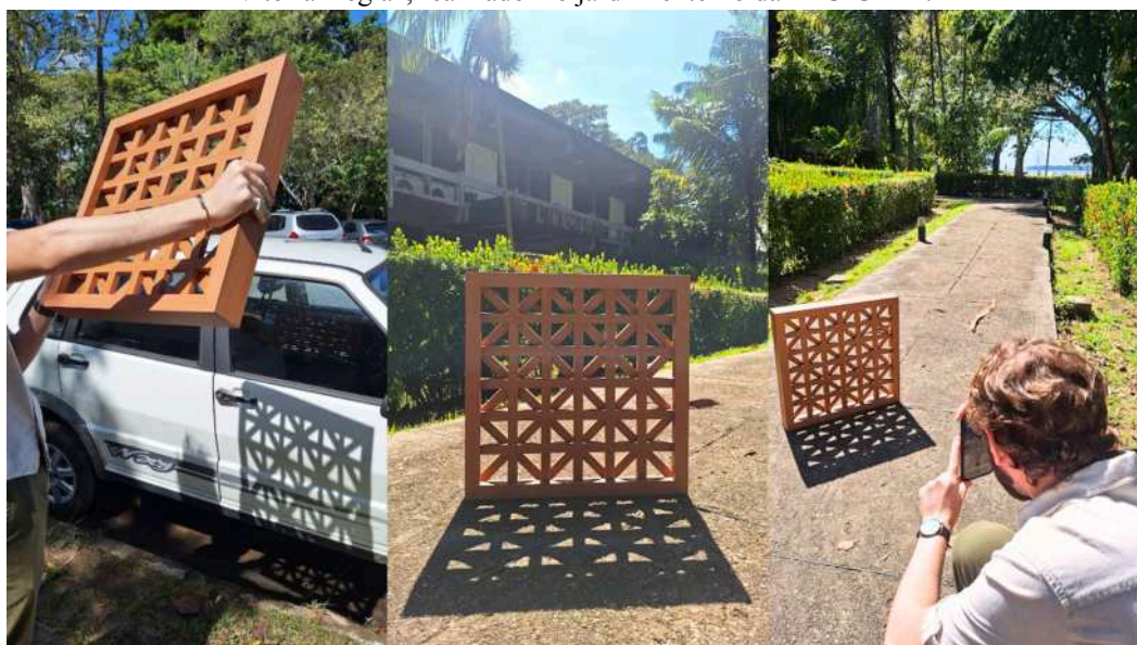
Figura 70 - Testes de volumetria e sombreamento com o protótipo do Muxarabi Amazônico “Vitória-Régia”, realizado no jardim externo da FAU-UFPA.
