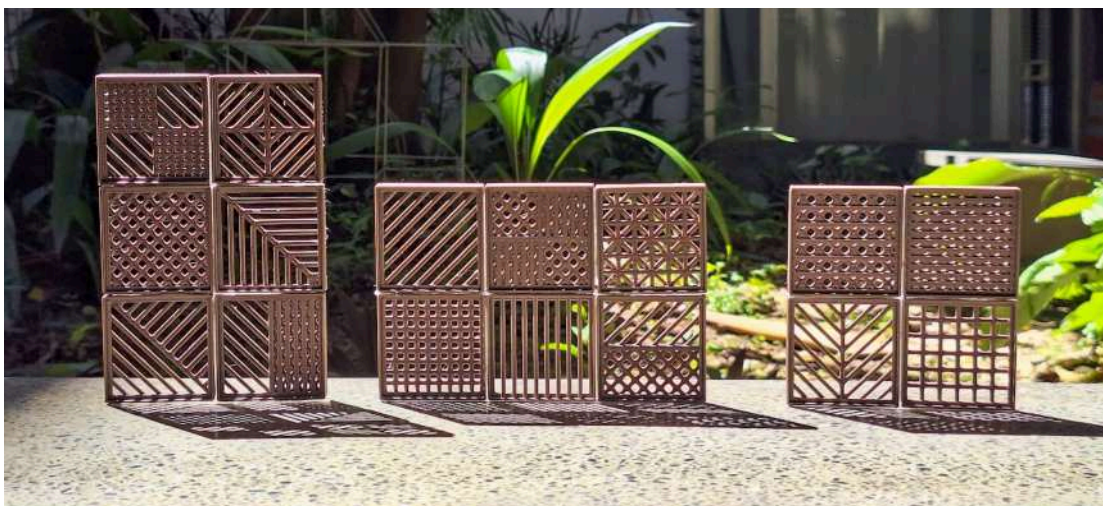
Figura 65 - Protótipos, em escala 1:10, dos Muxarabis Amazônicos. Ensaio realizado no jardim interno da FAU-UFPA
