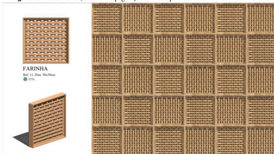
Figura 46 - Vista frontal, Vista 3D e paginação formada pelo Muxarabi Amazônico “Farinha”
