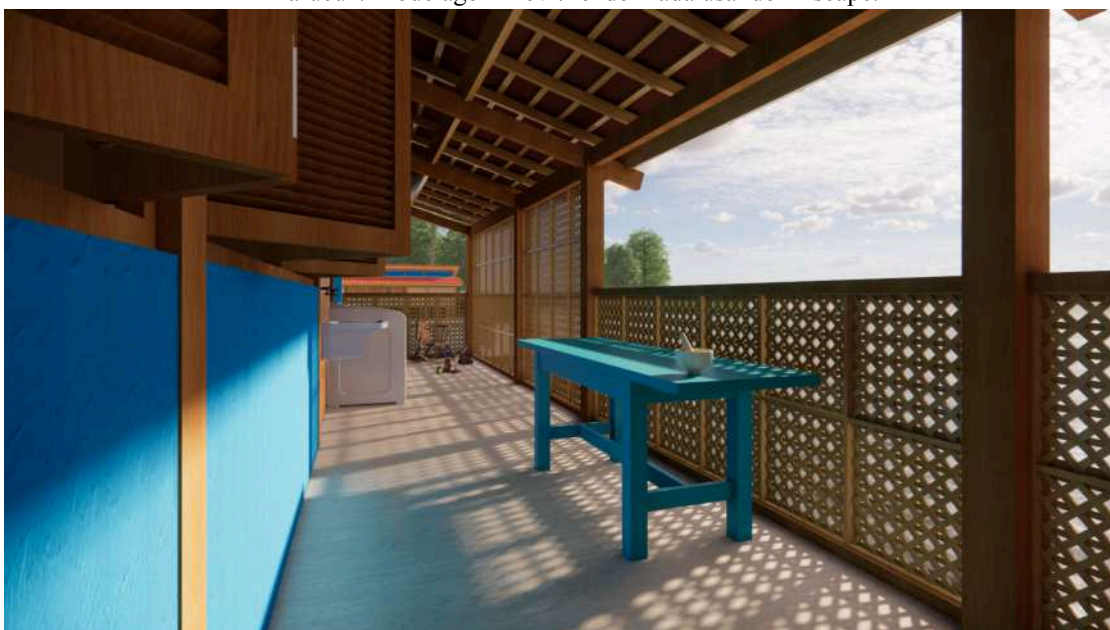
Figura 87 - Vista interna da varanda da habitação do Projeto Vigilenga, com adição do muxarabi “Pirarucu”. Modelagem Revit renderizada usando Enscape.
