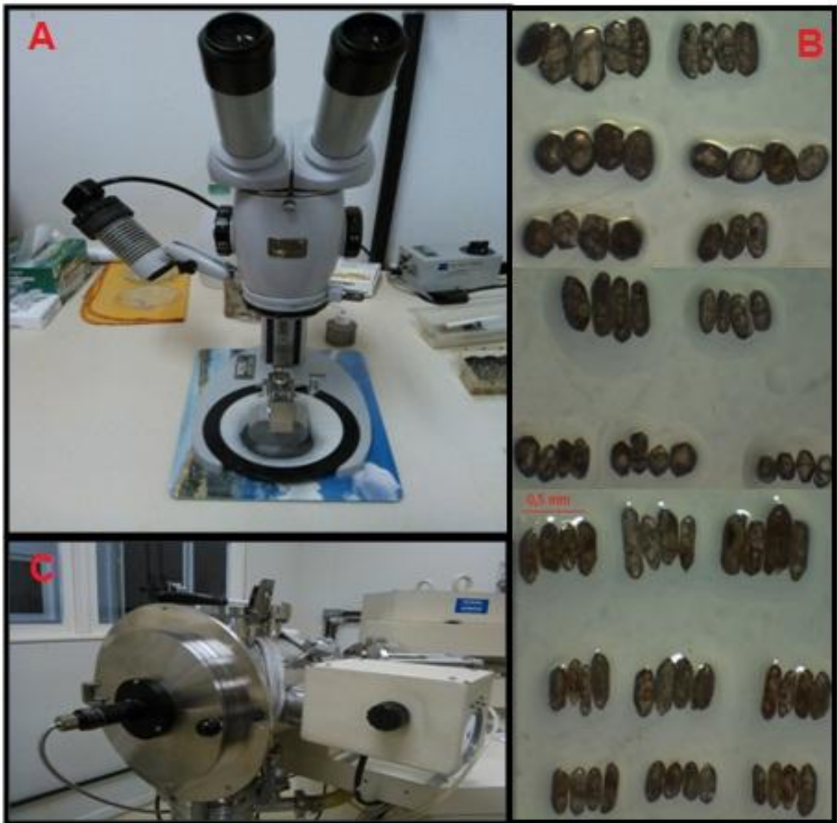
Figura 1.3 - Equipamentos utilizados na separação e escolha dos grãos de zircão. Em 'A' lupa binocular; em 'B' o grupo de zircões separados em 20 grupos de 4 zircões; e em 'C' Espectrometro de Massa de Termo-Ionização com multicoletor, Finnigan MAT 262 (TIMS).
