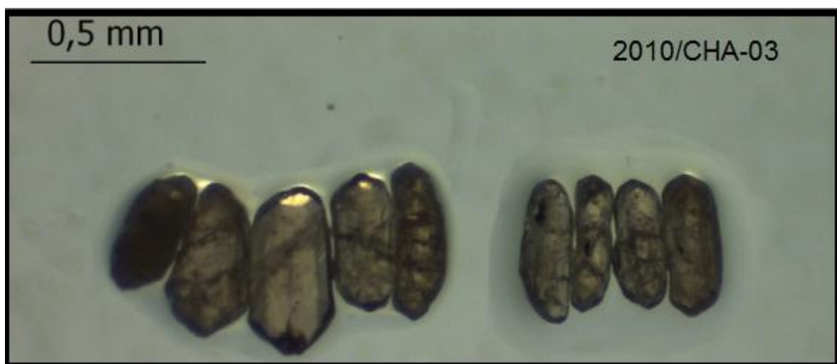
Figura 6.6 - Zircões analisadas da amostra 2010/CHA-03 que não obtiveram resultados satisfatórios para o procedimento de datação.
