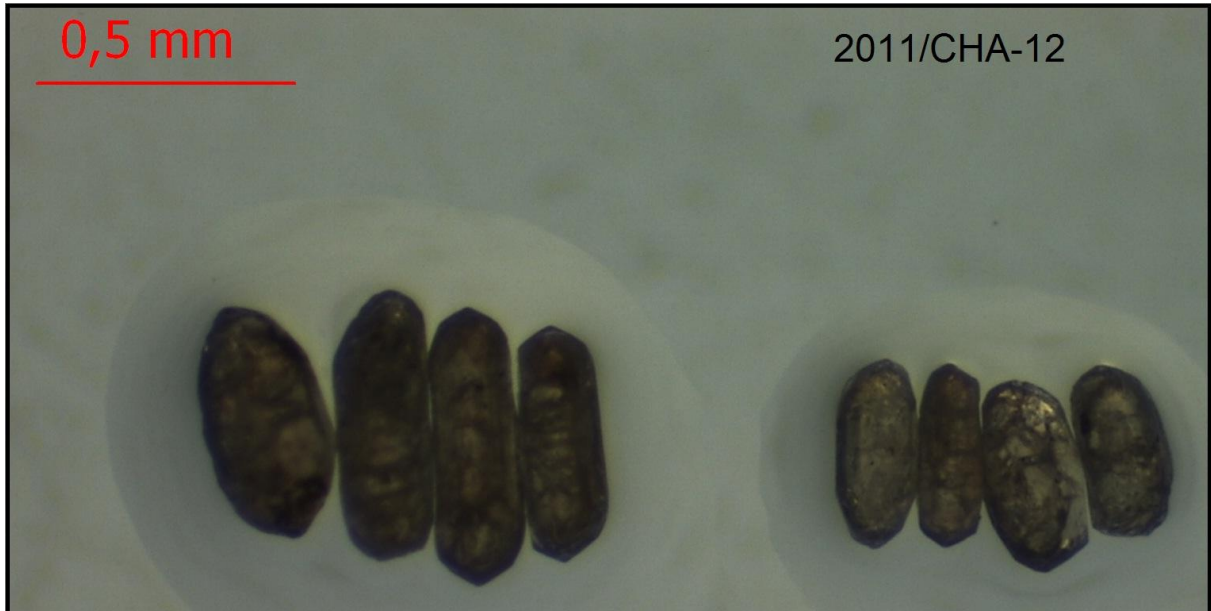
Figura 6.7 - Zircões analisadas da amostra 2010/CHA-12 que não obtiveram resultados satisfatórios para o procedimento de datação.
