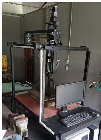
(b) CNC de soldagem construída manualmente.
