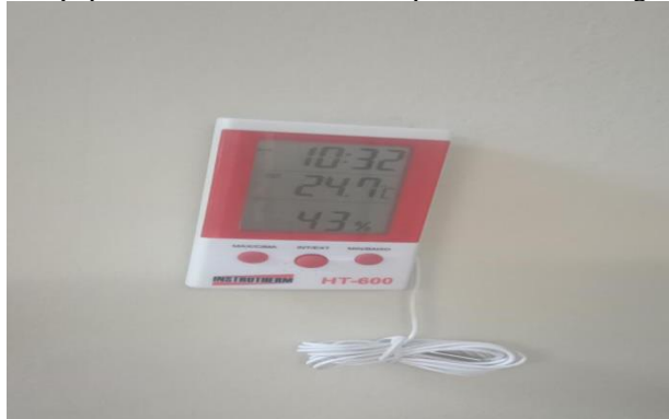
Figura 6: Equipamento de controle de temperatura - termo-higrômetro.
