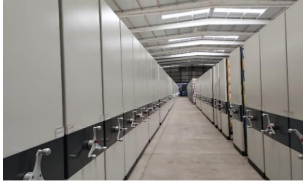
Figura 4: Estantes de aço deslizantes.
