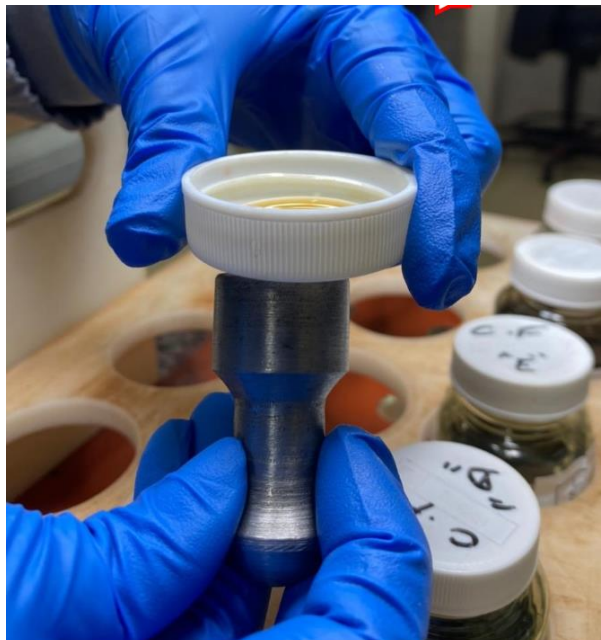
Figura 15 – Avaliação do nível de limalhas na amostra com auxílio de ímã.
