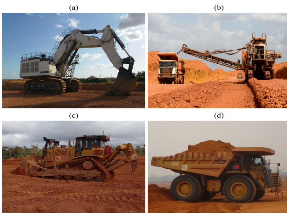
Figura 1 – Equipamentos móveis de grande porte: (a) Escavadeira Hidráulica; (b) Minerador de superfície; (c) Trator de esteira; (d) Caminhão fora de estrada.
