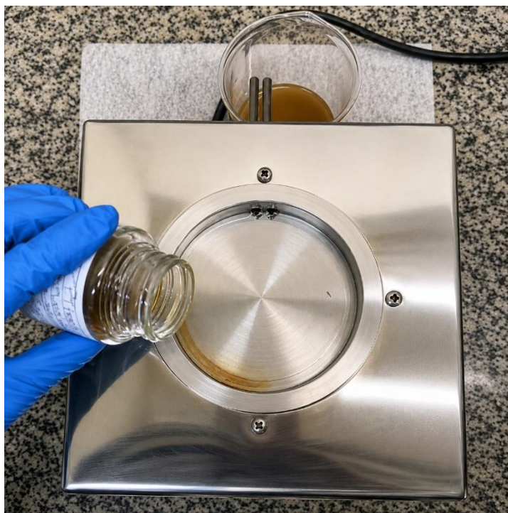
Figura 12 – Chapa aquecedora utilizada no ensaio de crepitação.
