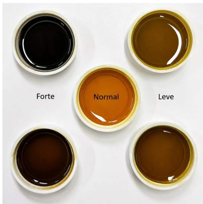
Figura 17 – Padrão para classificação do escurecimento do óleo lubrificante.
