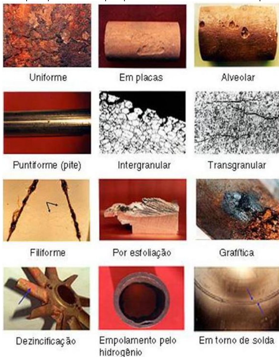
Figura 3 – Exemplos representativos das principais formas de corrosão observadas em superfícies metálicas
