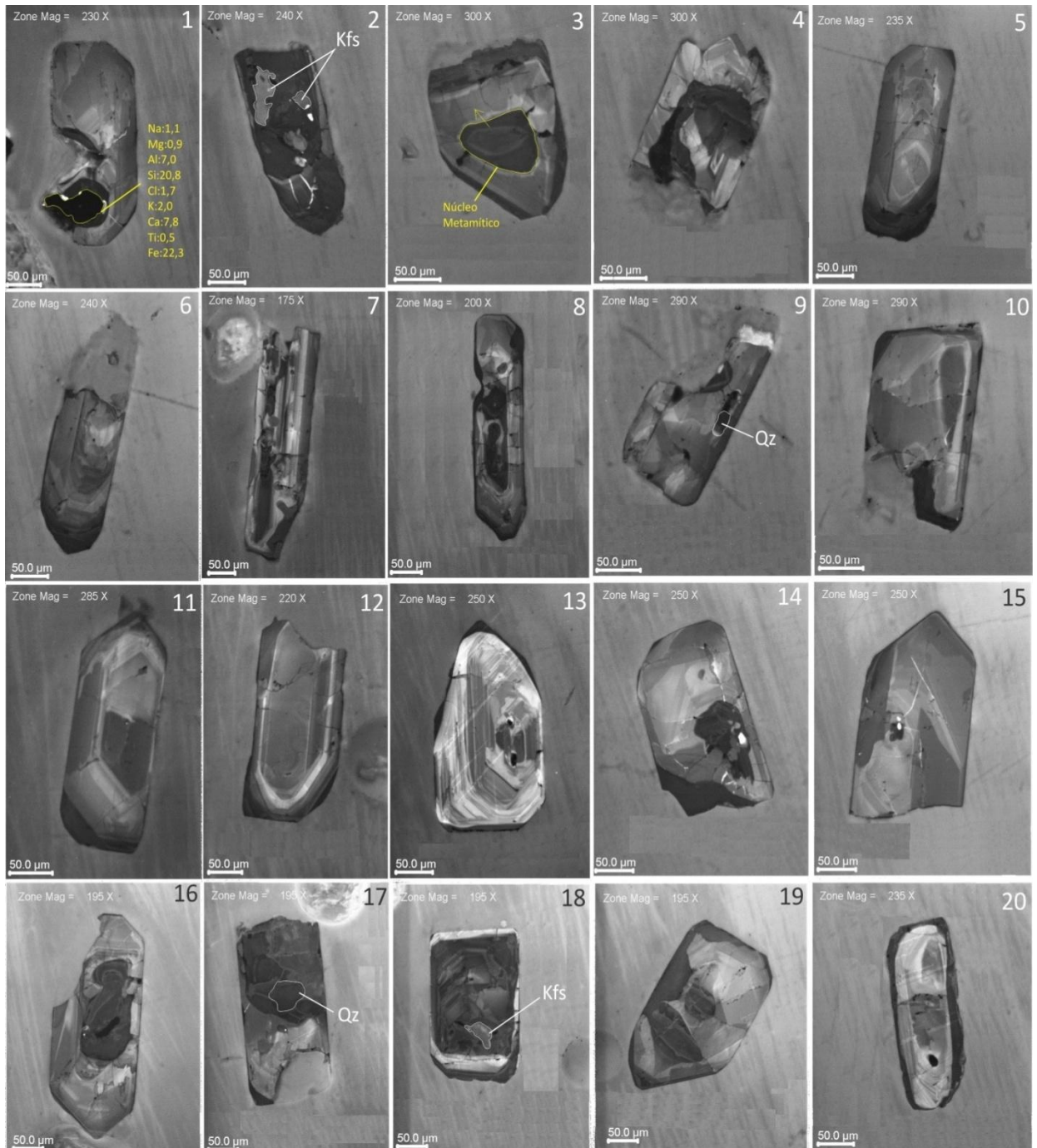
Figura 34- Imagens de catodoluminescência representativas dos zircões da amostra MD-02. Kfs= K-feldspato; Qz= quartzo.
