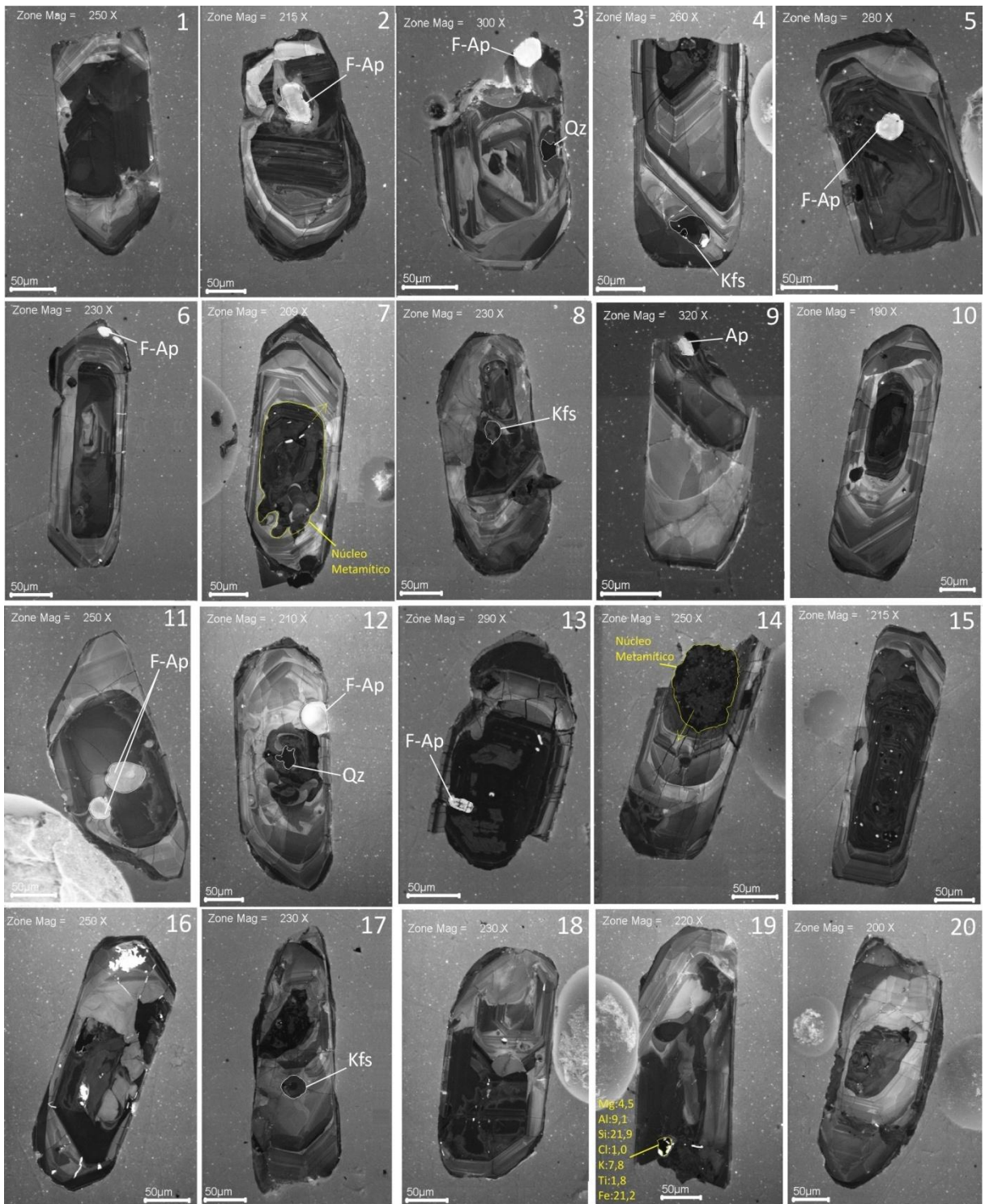
Figura 28- Imagens de catodoluminescência representativas dos zircões da amostra AMP-27. F-Ap= flúor apatita; Kfs= K-feldspato; Qz= quartzo.
