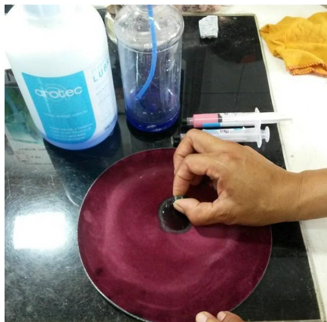
Figura 4- Exemplo de polimento manual das seções. Laboratório de Laminação (PPGG-IG-UFGA).
