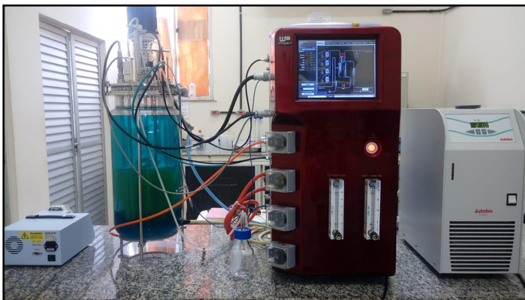
Figura 4 - Foto do biorreator tanque agitado propriedade do LabISisBio da UFPA. Utilizado para obter os resultados experimentais deste trabalho.
