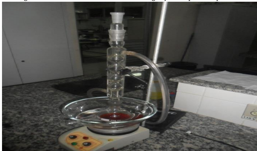
Figura 23: Mistura reacional em constante agitação no aparato experimental
