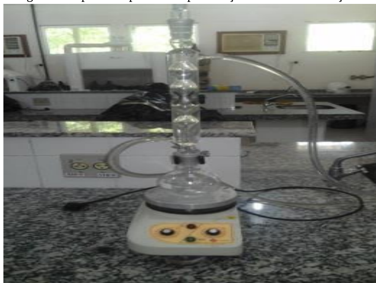
Figura 16: Aparato experimental para reação de transesterificação
