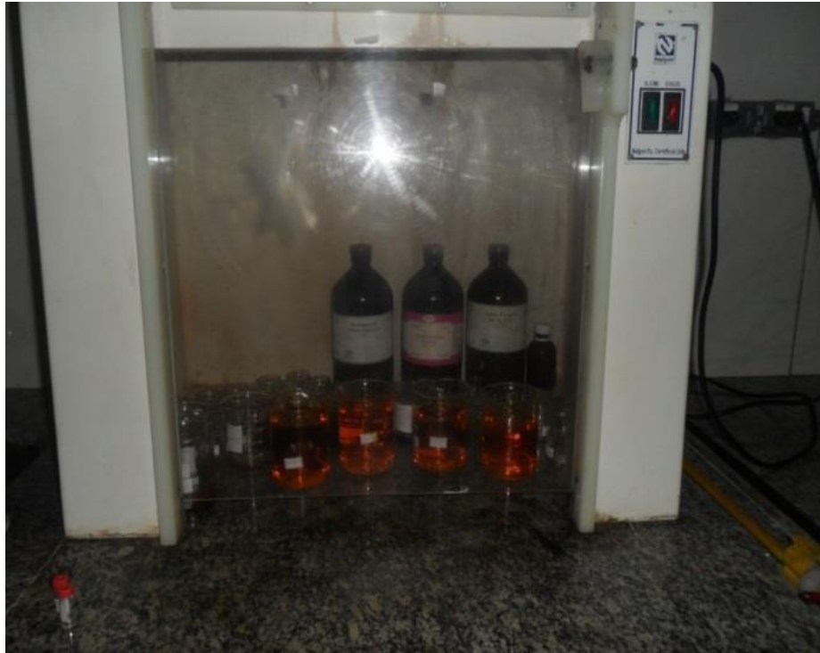
Figura 14: evaporação do solvente em capela de exaustão
