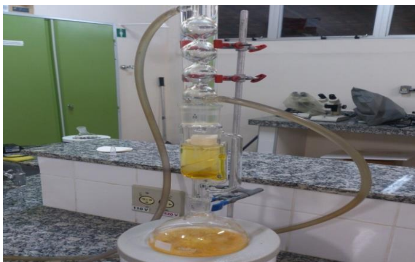
Figura 13: Processo de extração do óleo de buriti em Soxhlet
