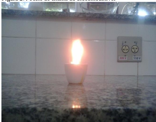
Figura 27: Teste de chama do biocombustível
