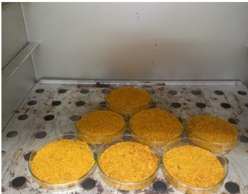
Figura 11: Retirada da umidade contida na polpa de buriti
