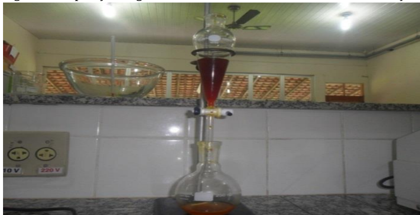
Figura 24: Separação da glicerina do biodiesel através do funil de decantação
